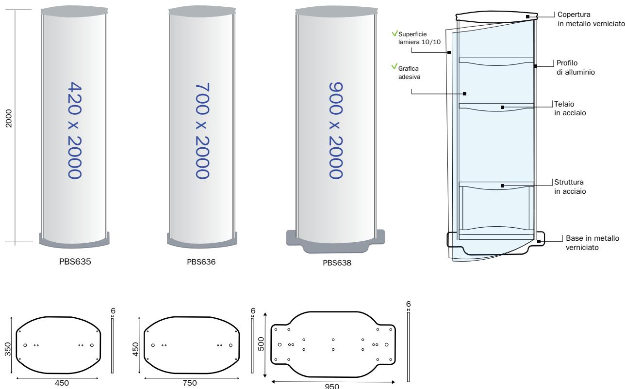
Totem pubblicitario con lastra in lamiera 10/10. Struttura con profili in alluminio e struttura scheletro interno in acciaio. Base e coperchio superiore in metallo verniciato a polveri colore silver. Superfici espositive in pannelli di lamiera 10/10. La grafica può essere applicata direttamente sul pannello in lamiera, mediante grafica adesiva. Base in metallo verniciata a polveri silver con fori. Foglio di protezione antiriflesso non incluso.
