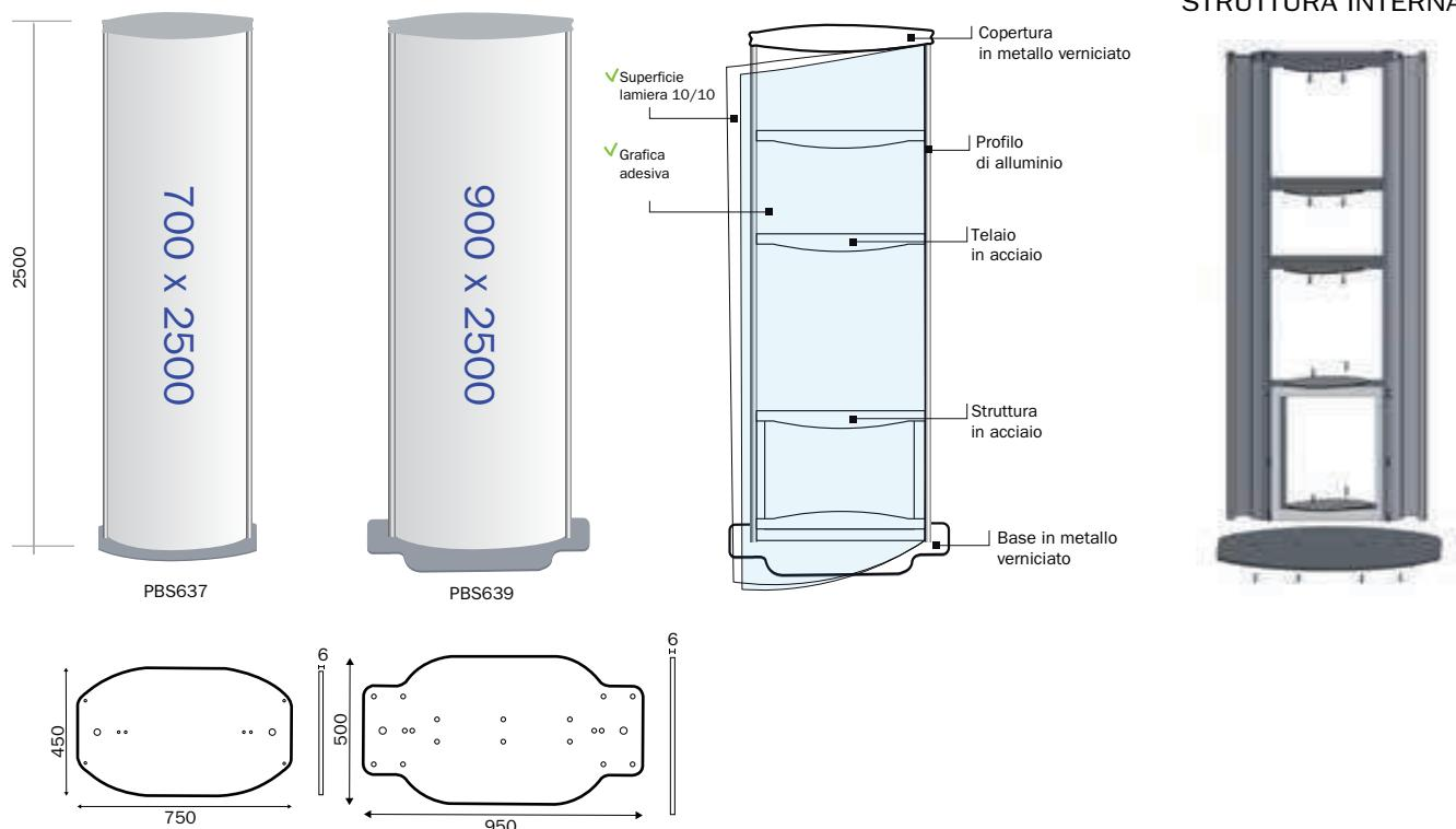
Totem pubblicitario con lastra in lamiera 10/10 preverniciata bianca. Struttura con profili in alluminio e struttura scheletro interno in acciaio. Base e coperchio superiore in metallo verniciato a polveri colore silver. Superfici espositive in pannelli di lamiera 10/10. La grafica può essere applicata direttamente sul pannello in lamiera, mediante grafica adesiva. Base in metallo verniciata a polveri silver con fori. Foglio di protezione antiriflesso non incluso.
